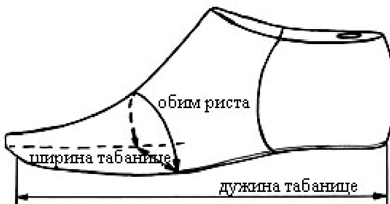
Слика 1. –Основне димензије калупа ЧВУ
