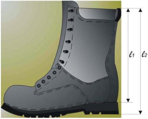
Слика 6 — Изглед и спољне димензије чизме
