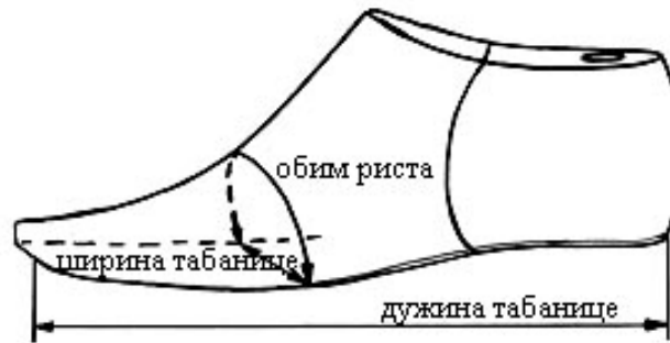
Слика 1. –Основне димензије калупа ЦВУ за МнОп
